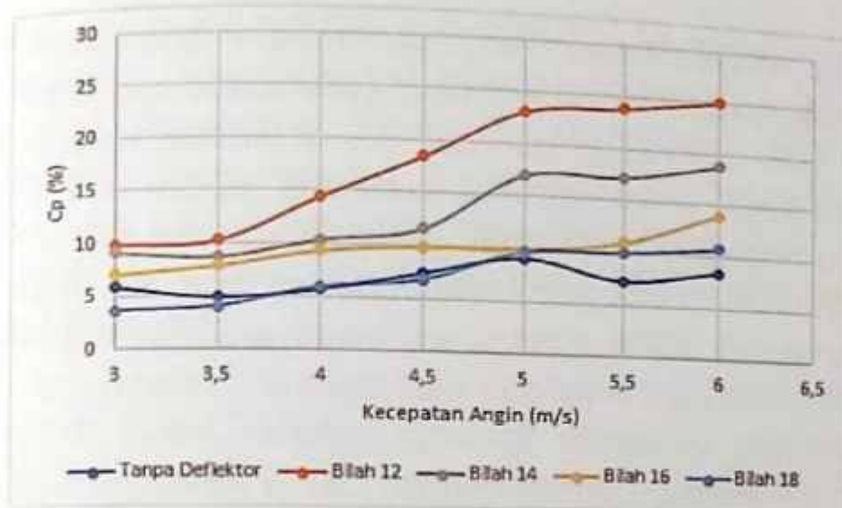
Gambar 3.28. Koefisien Kinerja Maksimum dari Model Turbin Angin dengan Plat Berayun Bebas pada Tiap Kecepatan Angin dengan Variasi Jumlah Bilah Pengarah pada ODGV
